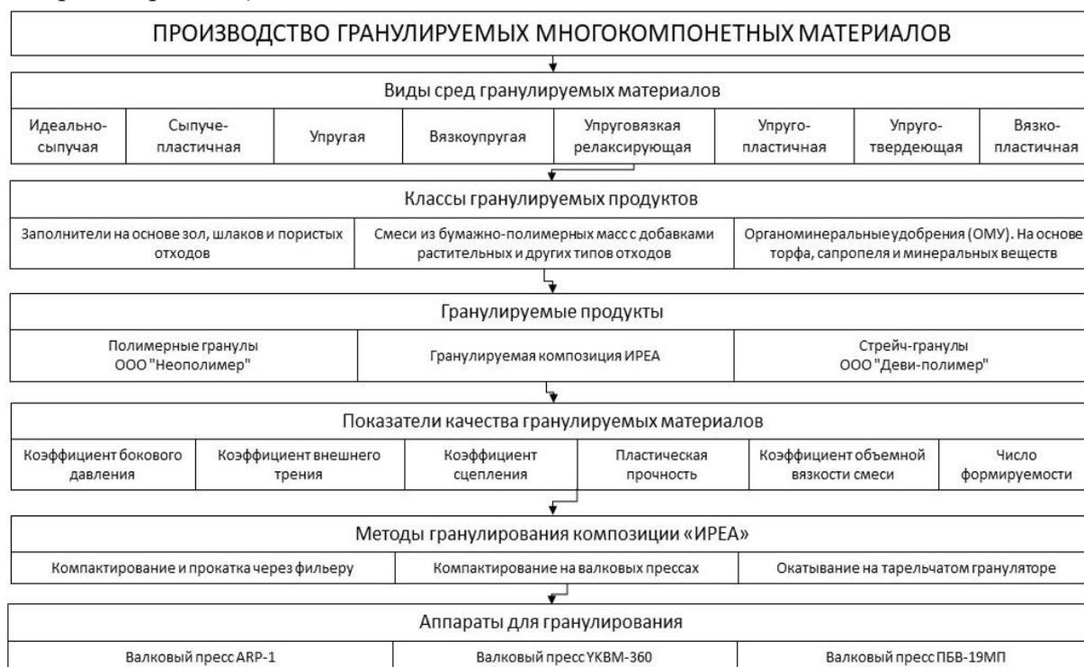
**Рис. Структура информационной модели производства гранулированных МКМ**
